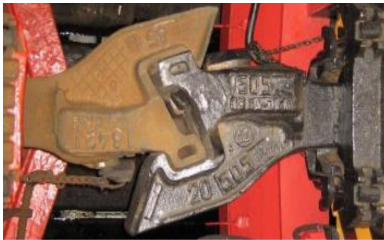
Рисунок 1.1 – Загальний вигляд принципу автозчеплення вагона
