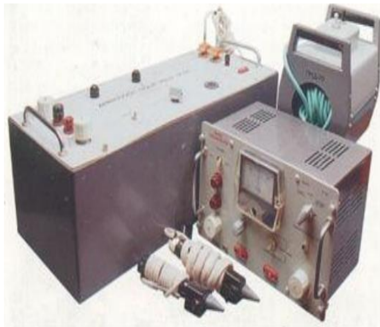
Рисунок 2.14 – Магнітопорошковий дефектоскоп ПМД-70
