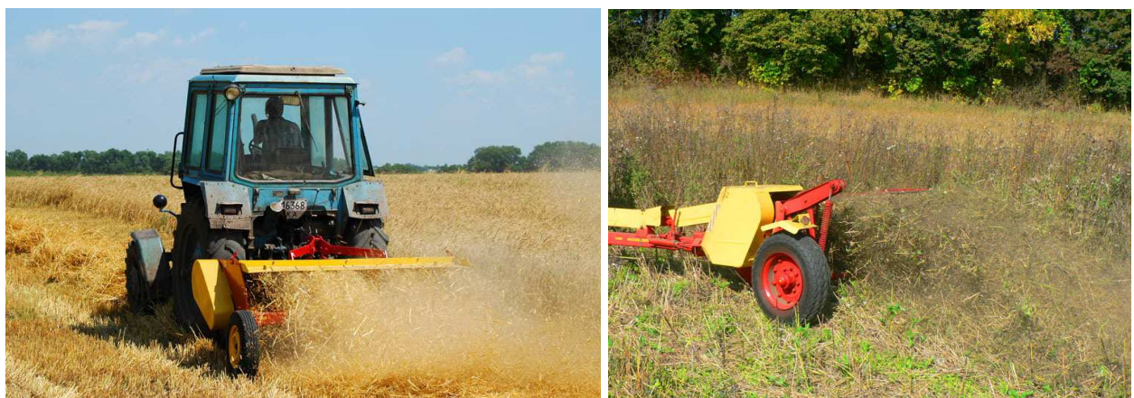
Рис. 1.3. Технологічна операція подрібнення залишків рослин начіпним (а) та причіпним (б) роторним мульчувачем
