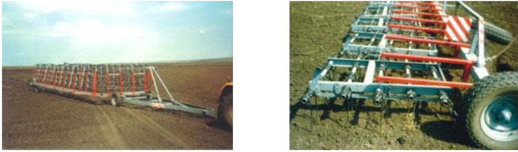
Рисунок 3.2 – Борона причіпна гідрофікована ЗПГ-24
