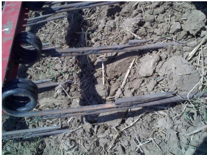
Рисунок 3.4 – Наварювання пружинних стержнів
