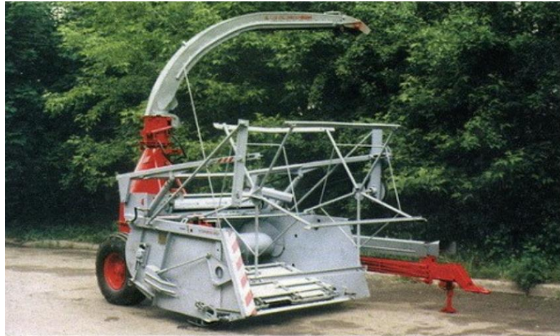
Рисунок 2.6 – Комбайн причіпний КПИ-2,4 з жаткою для збирання кукурудзи
