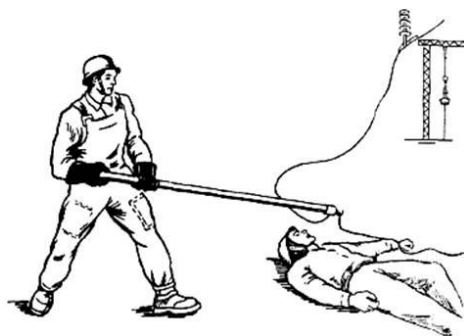
Рисунок 3.2 – Звільнення потерпілого від дії струму в електроустановках напругою понад 1000 В ізольовуючою штангою
