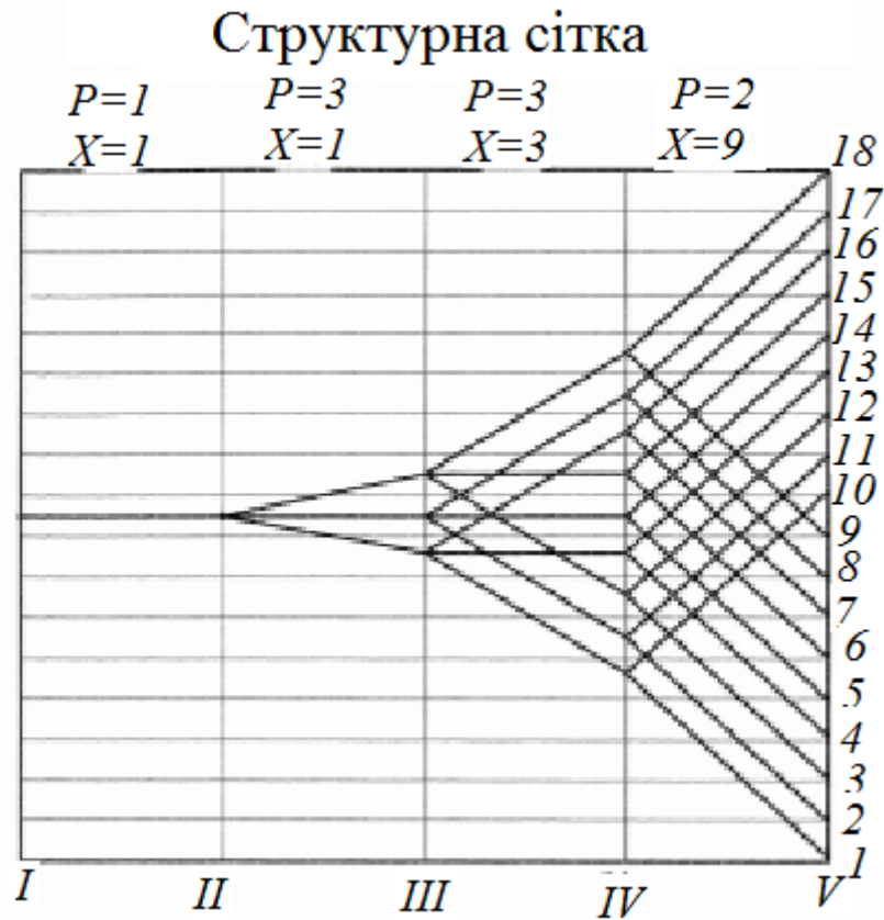
Рисунок 2.6 - Структурна сітка коробки швидкостей
