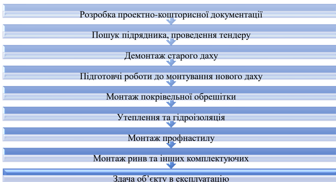
Рисунок 3.6 – Етапи здійснення ремонту покрівлі Будинку культури у с. Скоморохи
