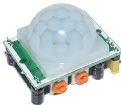
Рисунок 3.3 - Датчик руху HC-SR501
