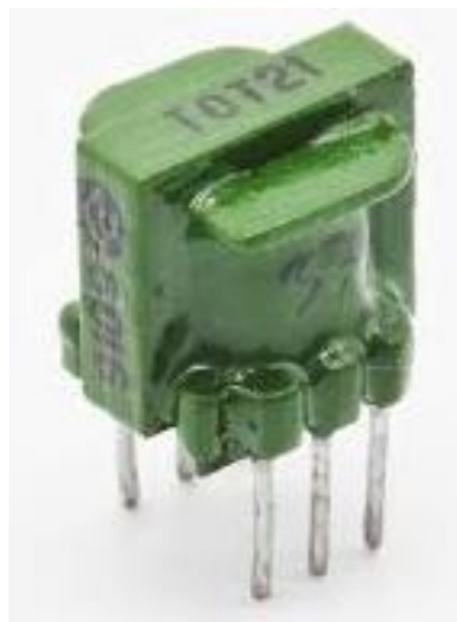
Рисунок 1.41 – Конструктивне виконання трансформатора TOT21
