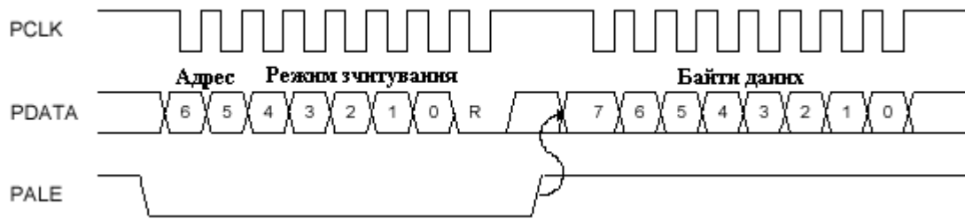
Рисунок 1.18 – Діаграма стану регістру під час читання
