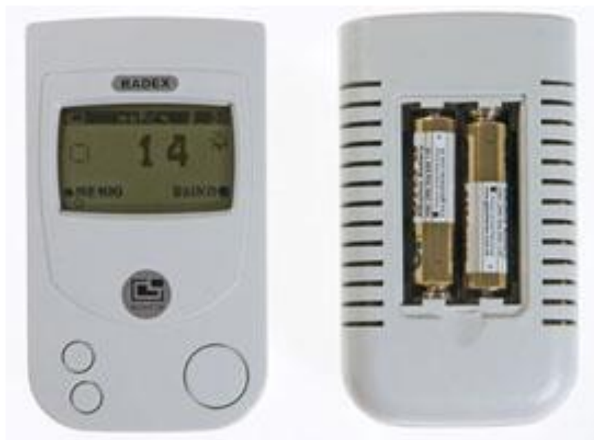
Рисунок 1.1 – Радіоактивний індикатор RADEX РД 1503 [10]
