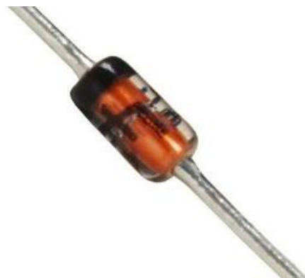
Рисунок 1.29 – Конструктив діоду 1N4148
