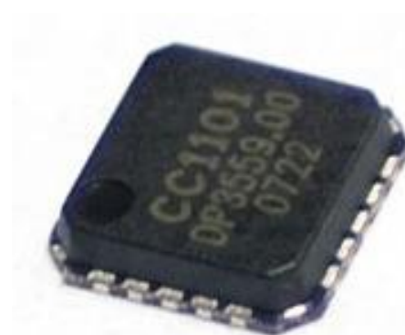
Рисунок 1.34 – Конструктивне виконання CC1101
