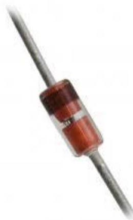
Рисунок 1.31 – Конструктив діоду BZX79C5V6
