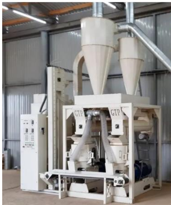
Рисунок 3.3 – Зовнішній вигляд гранулятора із плоскою матрицею «ГК Біокопром», який гранулює органо-мінеральні добрива
