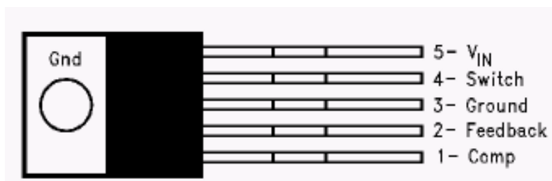
Рис. 1.12. Виводи (зігнуті, розташовані в шаховому порядку) TO-220
