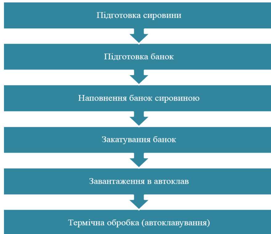
Рисунок 3.5 - Стадії технологічного процесу виробництва тушонок зі свинини
