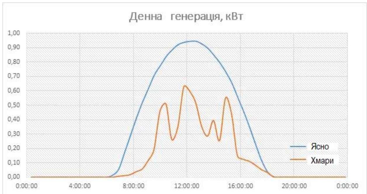
Рисунок 2.9 – Залежність генерації фотоелектричної батареєю від сонячного випромінювання (хмарності)
