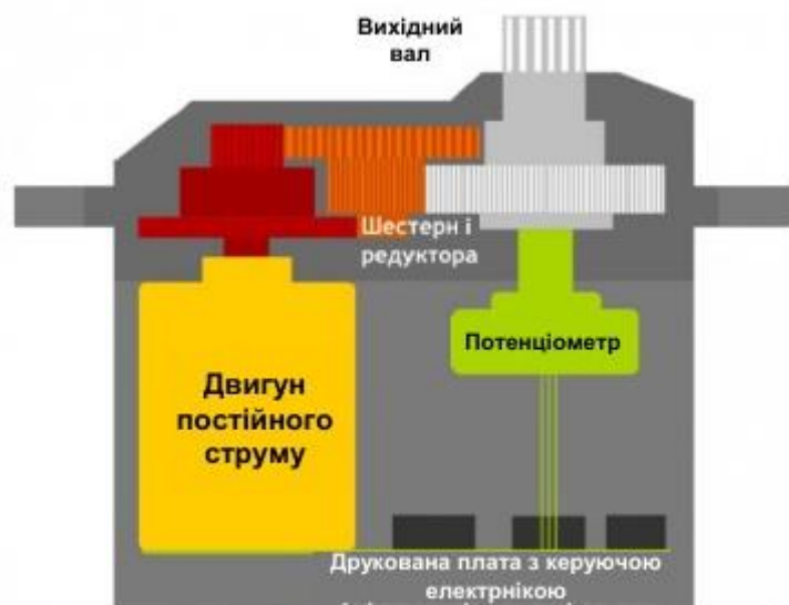
Рисунок 2.10 – Будова серводвигуна
