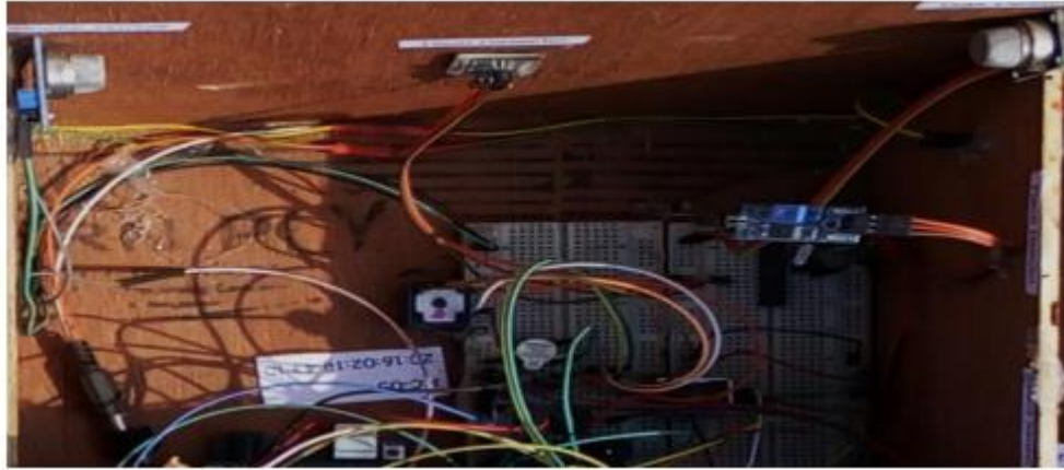
Рисунок 2.6 - Прототип контуру керування для кухні, обладнаної датчиком полум'я, газу, диму та тепла.
