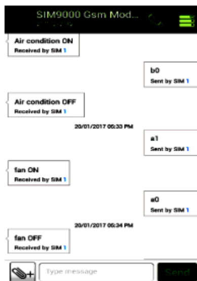
Рисунок 2.10 - SMS-контроль побутової техніки та підтвердження цих операцій через повідомлення.
