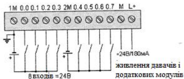
Рисунок 3.4 - Схема підключення дискретних датчиків до мікроконтролера
