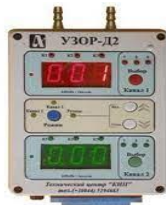
Рисунок 2.12 – Зовнішній вигляд лічильника – регулятора «УЗОР-Д2»
