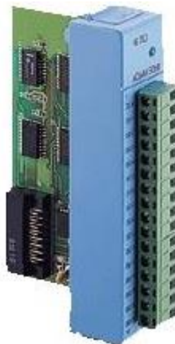
Рисунок 2.18. – Модуль дискретного виводу ADAM – 5056
