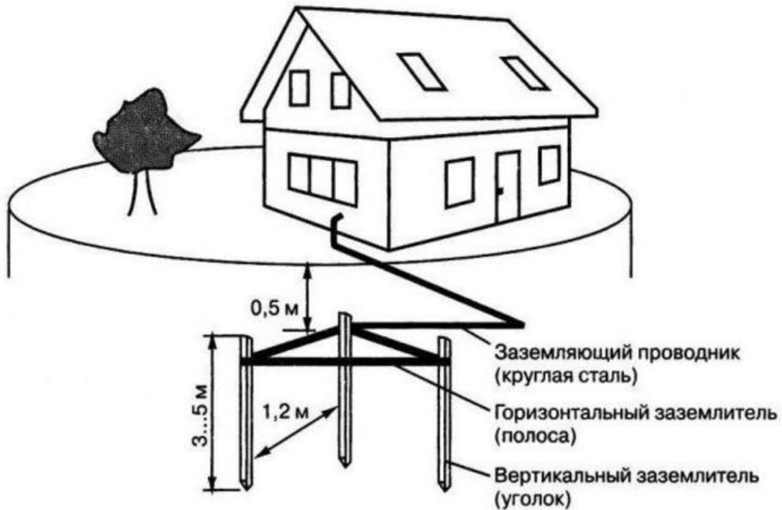
Рисунок 3.2 - Схема зовнішнього заземлюючого контуру.
