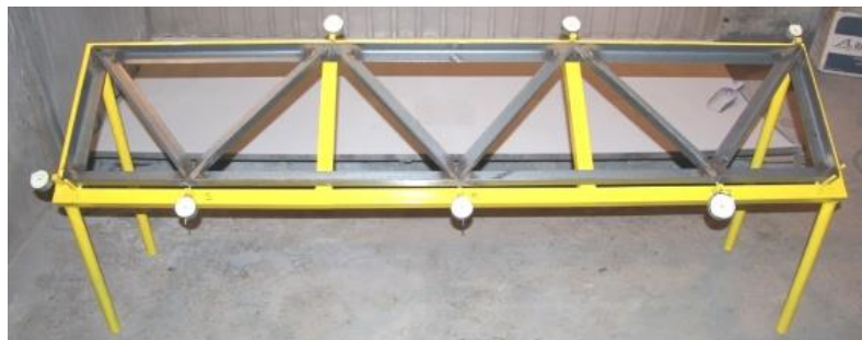
Рисунок 2- Пристосування для визначення температурних деформацій плоских ферм який
