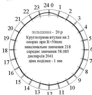
Рисунок 1 Усереднена круглограма згортної втулки сформованої при радіусі транспортного каналу R=50 мм і способі базування ФМ – оправка на 2-х опорах
