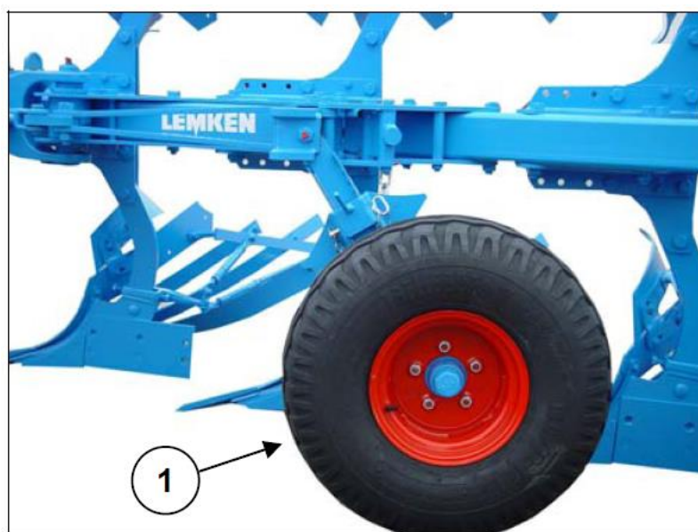
Рисунок 24 – Колесо Унірад – опорне/транспортне колесо
