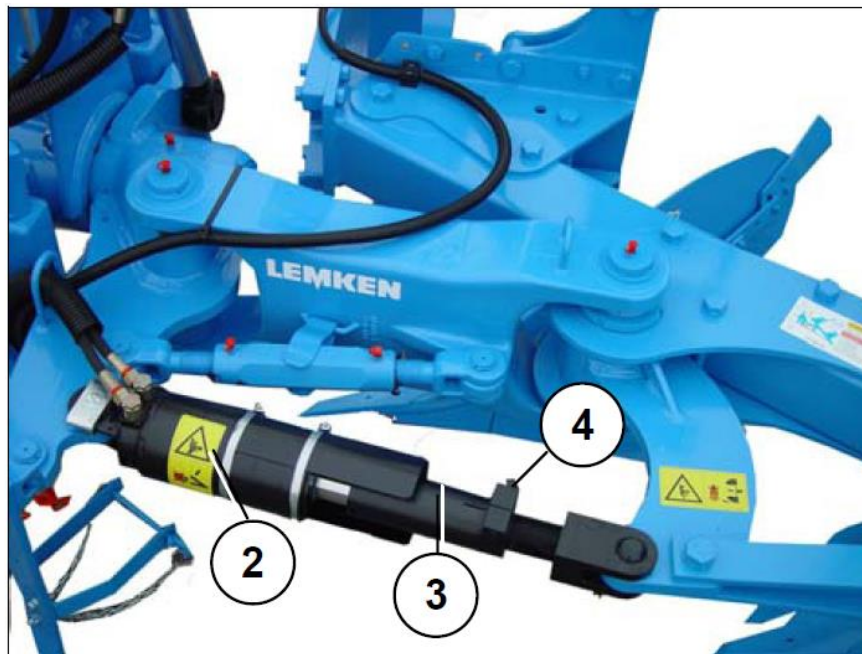
Рисунок 12 – Гідравлічне регулювання ширини передньої борозни
