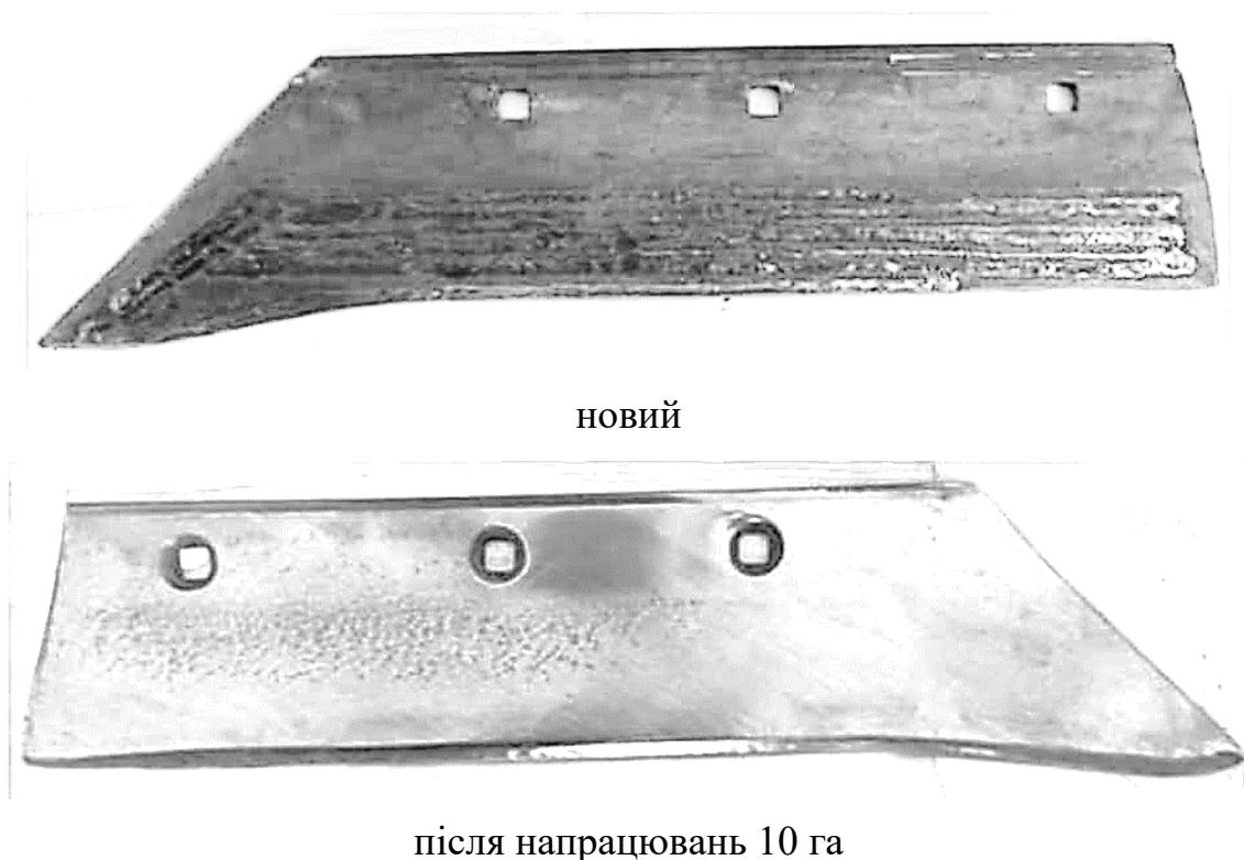
Рис.3.18 – Зміна кут заточування леза лемеха наплавленого електродом ОЗН-6 після експлуатаційних випробувань
