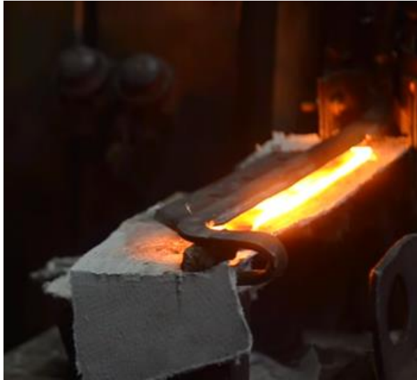
Рис. 2.13 Процес наплавлення леза лемеха індукційним методом
