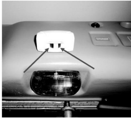
Рисунок 1.7 – Приклади встановлення пасивних інфрачервоних датчиків типу Ш2
