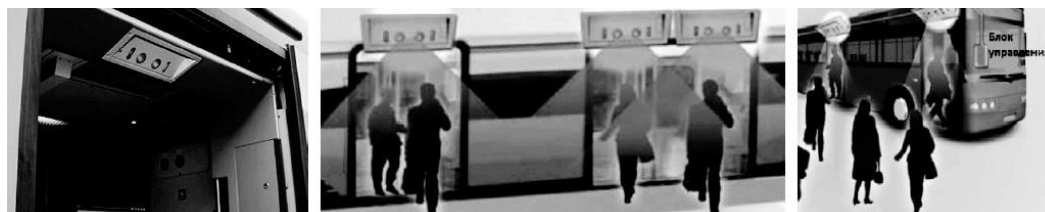
Рисунок 1.10 – 3D - датчики обліку пасажирів
