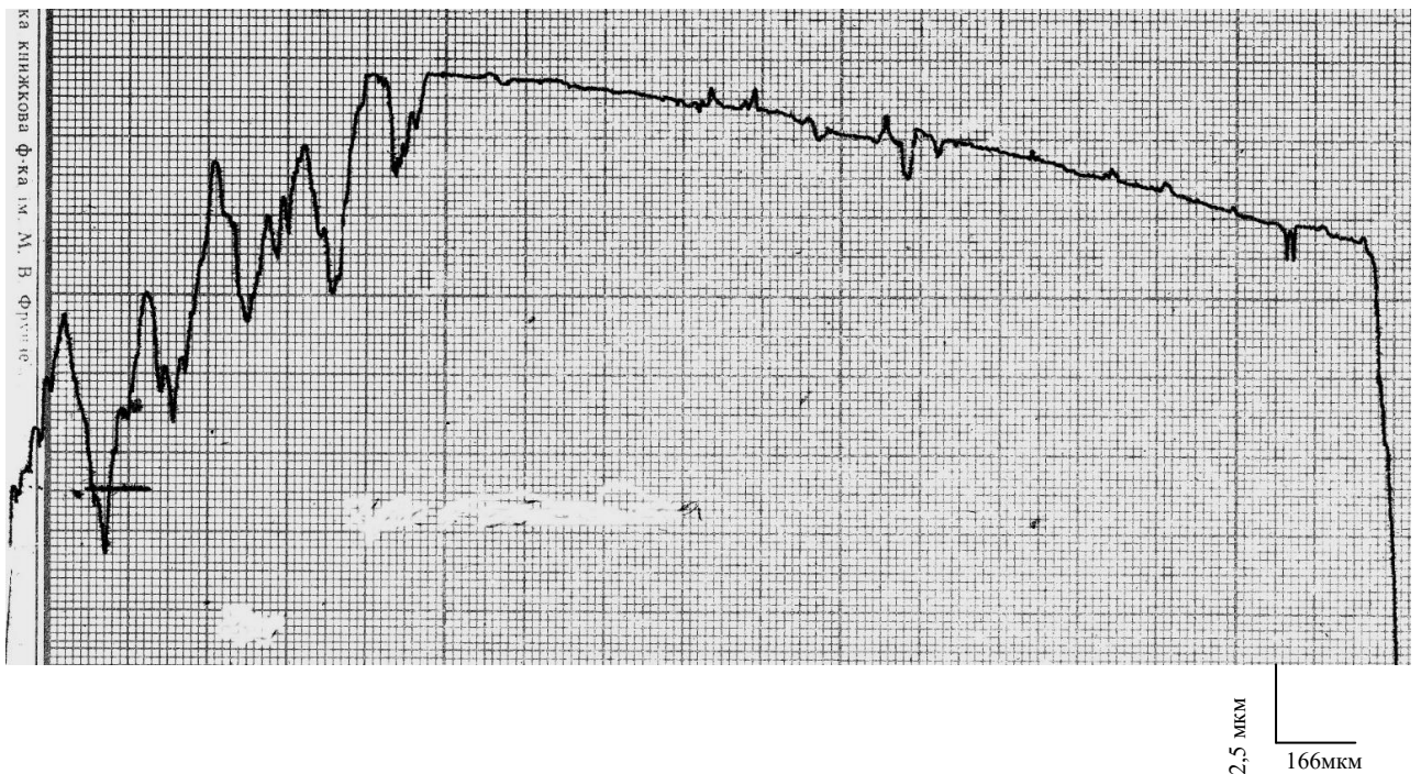
Рис.4.7. – Профілограма контрольного чавунного компресійного кільця з хвилинним конусом після запуску двигуна за стандартною технологією
