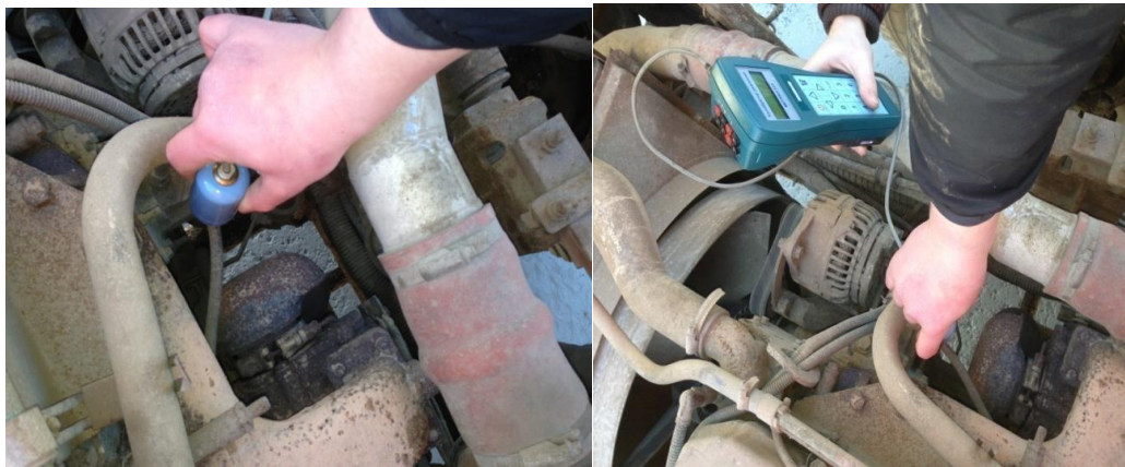
Рисунок 4.1 – Вимірювання калібратором тиску "Метран" розрідження в паливопроводі системи Common Rail
