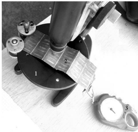
Рисунок 3.6 – Установа для вимірювання коефіцієнта пружності мембрани фільтрів:
