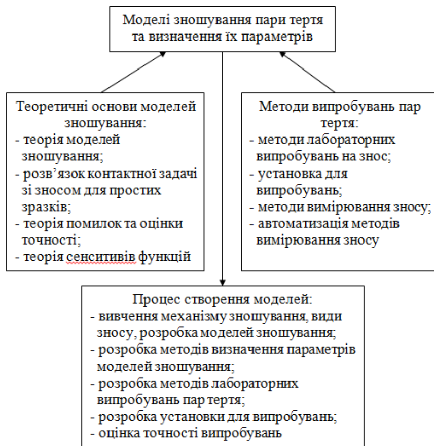
Рис. 4.1 – Схема визначення моделі зношування пари тертя
