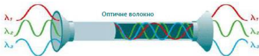
Рис. 3.1. Передача інформаційних потоків за технологією WDM
