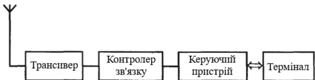
Рис. 2.1. Структура пристрою Bluetooth
