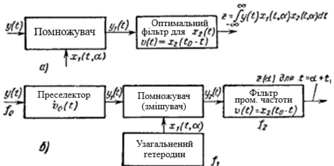
Рис. 1.5. Схеми кореляційно-фільтрової обробки: (а) - найпростіша схема без преселектора, (б) - узагальнена схема супергетеродинного прийому
