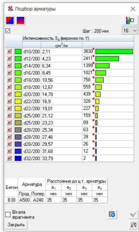
Рисунок 2.21 – Потрібні діаметри для армування плит перекриття (верхня X і Y)
