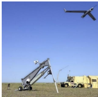
Рис. 1.3. БПЛА Scan Eagle, посадочно-пускова установка Skyhook і наземна станція управління
