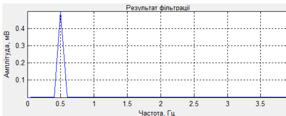
Рис.3.11. АЧХ цифрового узгодженого фільтру для еталону сигналу
