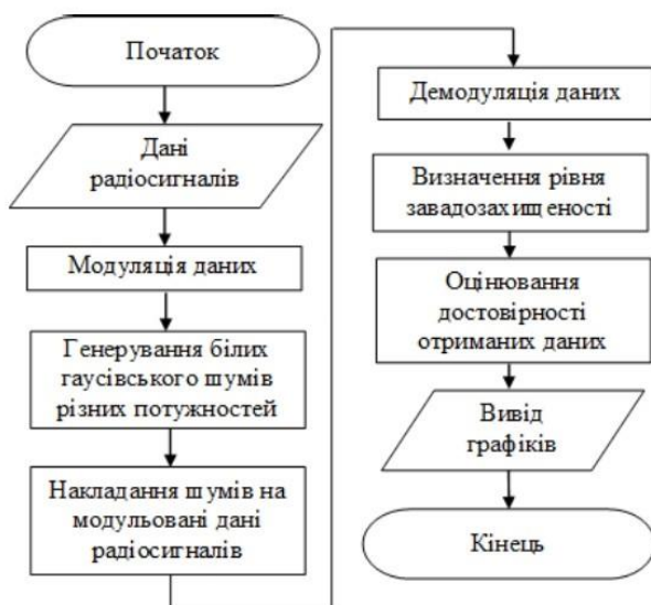
Рис.1. Алгоритм оцінювання завадозахищеності каналу зв'язку при різних модуляціях
