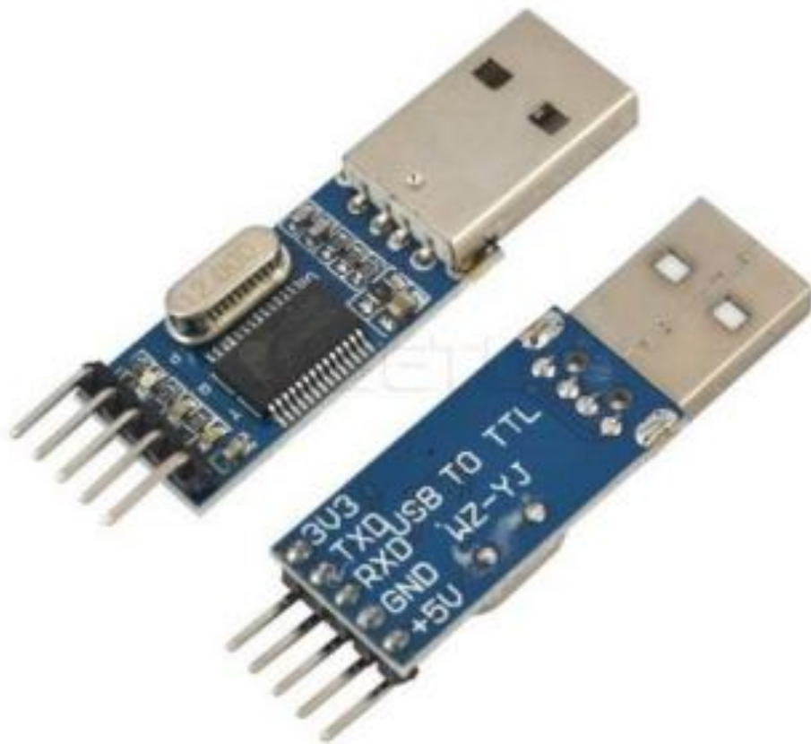
Рис. 3.5. Вид зверху та знизу конвертора PL2303
