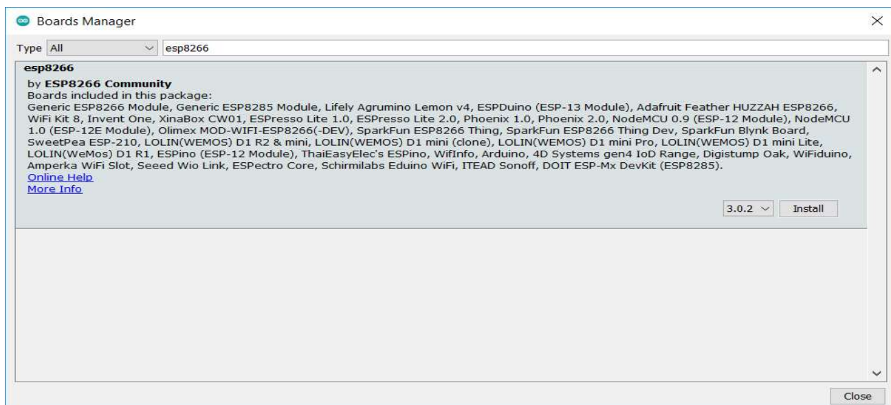
Рис. 3.6. Встановлення плагіна для роботи з платформою ESP8266 у вікні «Boards Manager»
