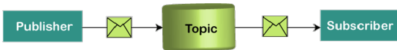
Рис. 2.9. Взаємодія видавця та підписника через теми повідомлень в MQTT
