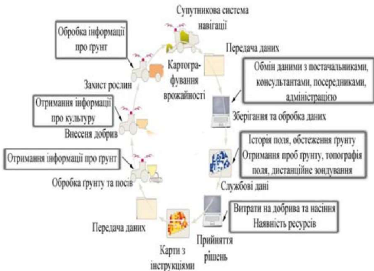
Рис. 1.2. Схема обміну інформацією в технології «розумного» землеробства на основі концепції IoT [4]
