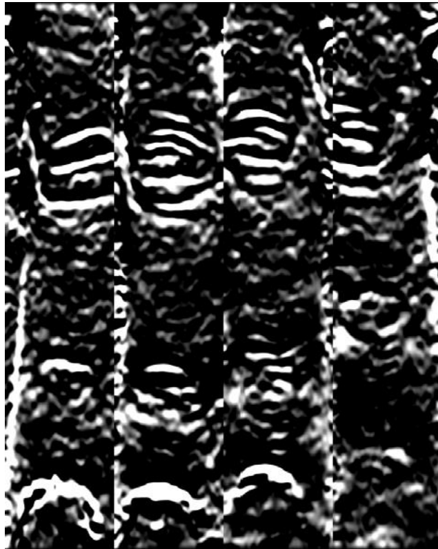
Рис. 2.10 – Результат застосування фільтра Габора до зображень пальців
