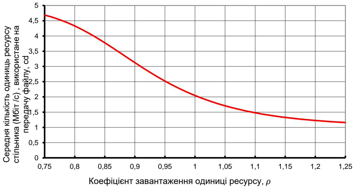
Рис. 3.12. Середнє використання ресурсу стільника на передачу файлу при збільшенні мінімального потенційного завантаження ресурсу передачі стільника
