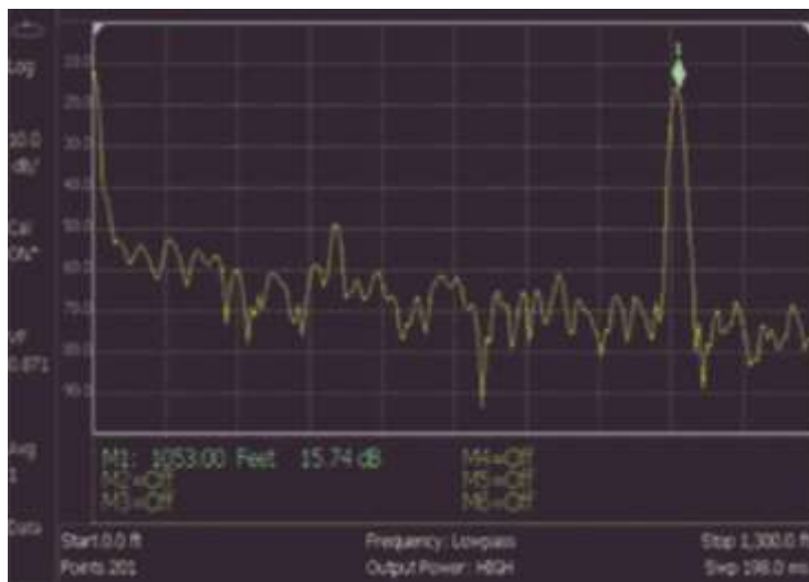
Рис. 1.6. Вимірювання в кабелі всередині приміщення
