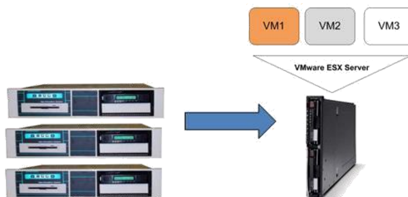
Рис.1.12. Заміна 3-х серверів одним за допомогою VMware
