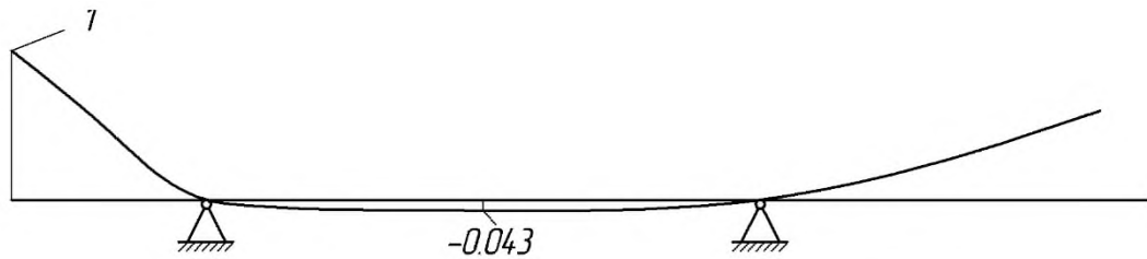
Рис. 2.28. Перша форма власних коливань шпинделя
