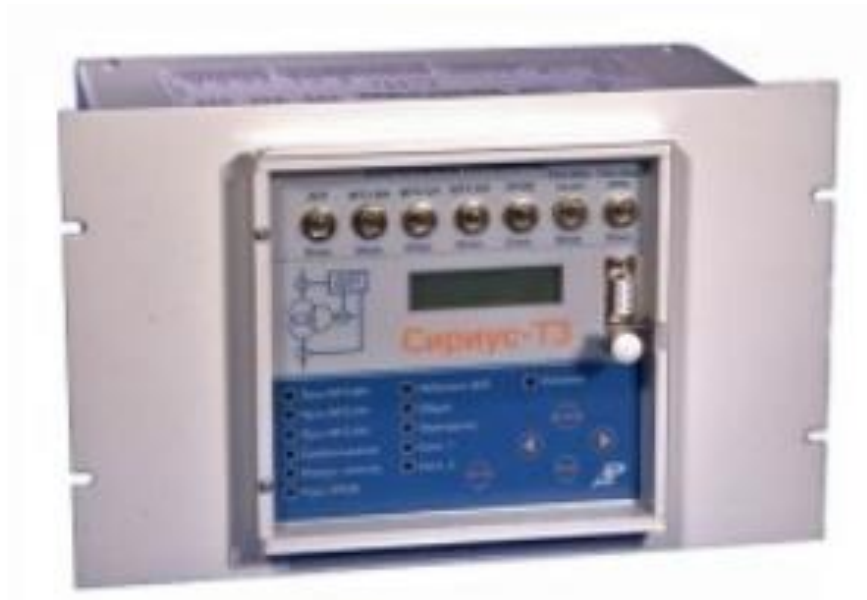
Рисунок 1.6 - Термінал захисту 3-обмоткового трансформатора Сіріус-Т3
