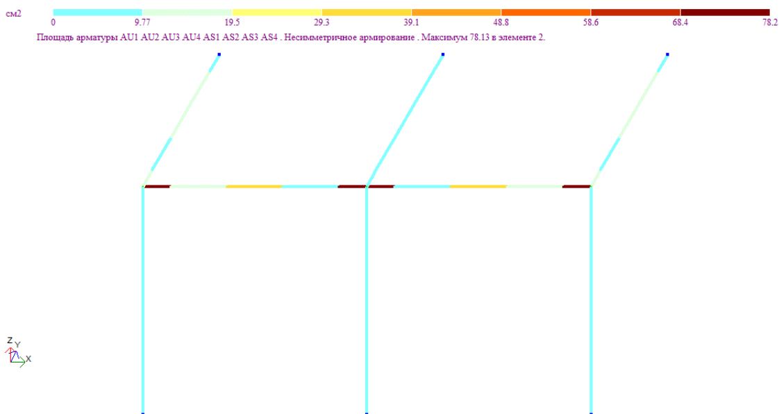
Рисунок 2.8 – Площа поперечного перерізу арматури при несиметричному армуванні.
