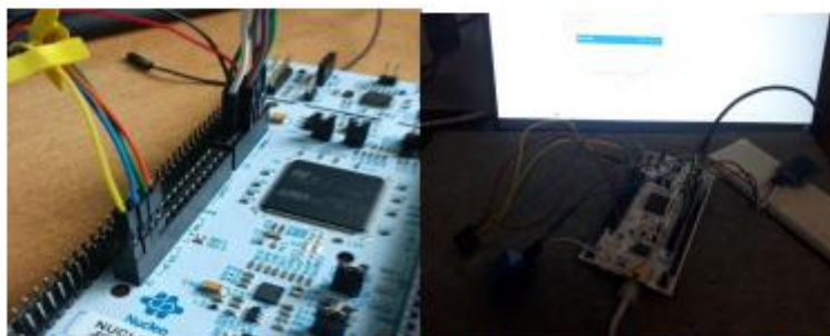
Рисунок 1 – Комп'ютерна система контролю процесу ферментації винних продуктів.
