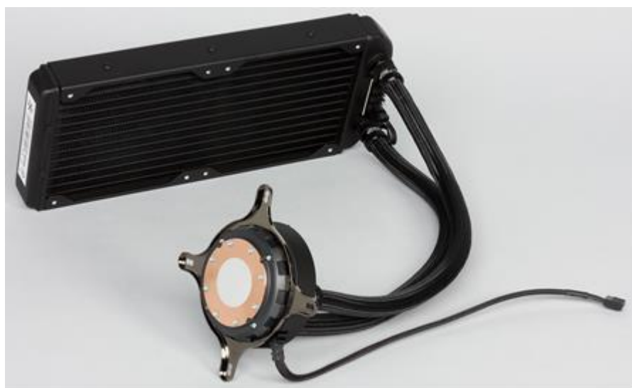
Рис 3.10 Водяний охолоджувач ТЕКТЕ шляхом циркуляції рідини
