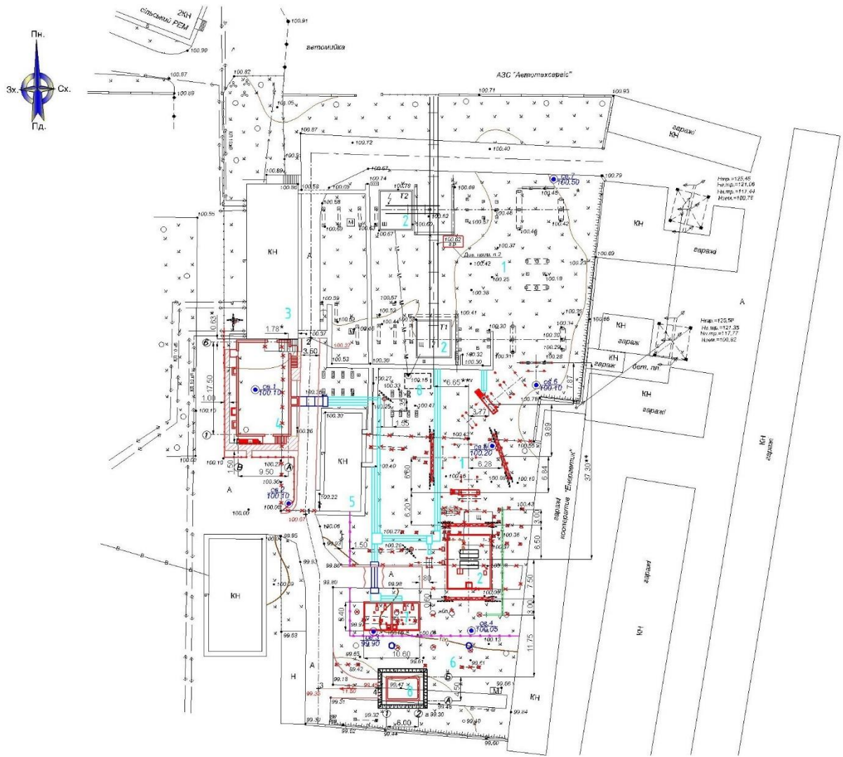
Рисунок 1.6 - Генеральний план трансформаторної підстанції 110/10 кВ “Галицька”.
