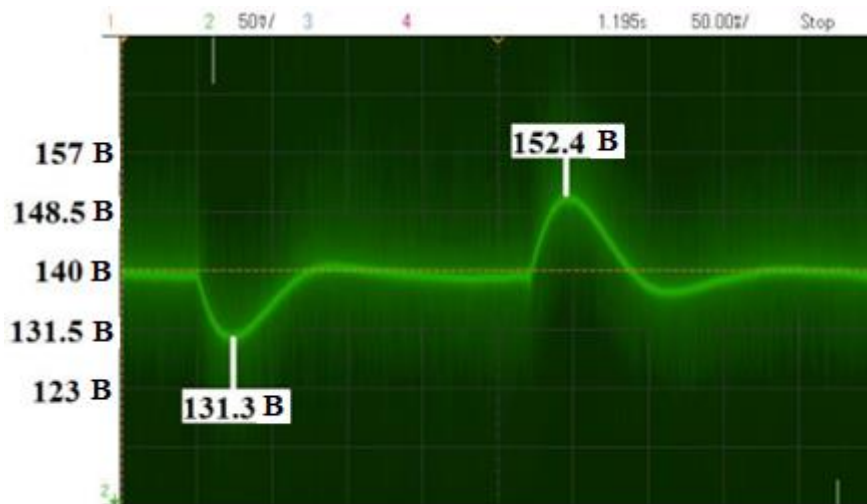
Рисунок 3.21 – Реакція вихідної напруги на ступінчасту зміну навантаження від 157 Ом до 103 Ом і назад, 50 мВ/розподіл, 50 мс/розподіл
