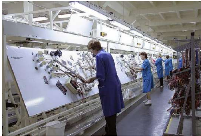
Рисунок 1.2 – Зображення конвеєра зборки кабельних джгутів із системою місцевого освітлення
