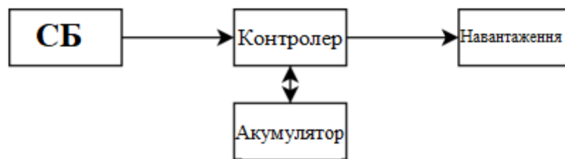
Рисунок 1.1 – Блок-схема сонячної фотоелектричної установки.
