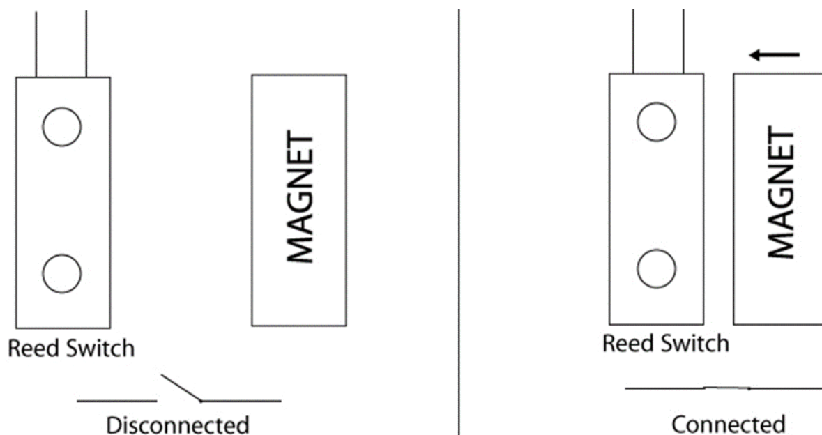
Рисунок 3.14 – Принцип роботи давача МС-38
