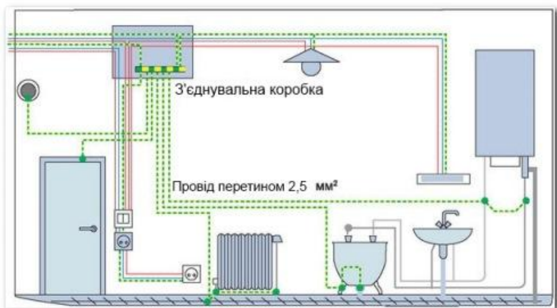
Рисунок 3.8 – Система зрівнювання потенціалів
