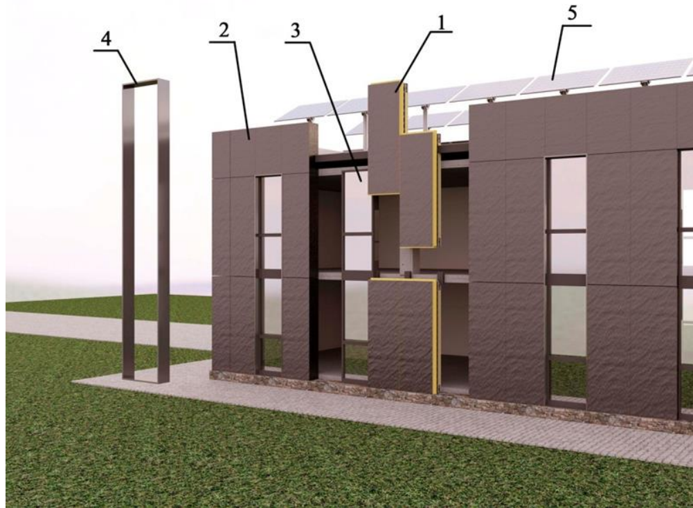
Рисунок 3.4 – Послідовність монтажу панелей ВФП.
