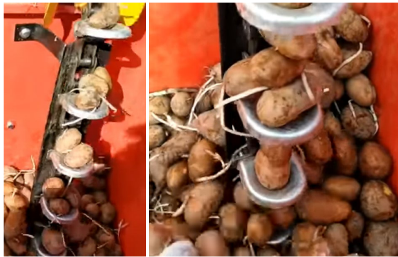
Рис. 2 – Фрагменти зйомки роботи посадочного апарату
