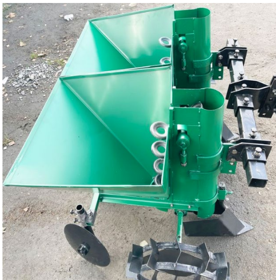
Рис. 1 – Класична конструкція картоплекосаджалки з конвеєрним апаратом [2]
