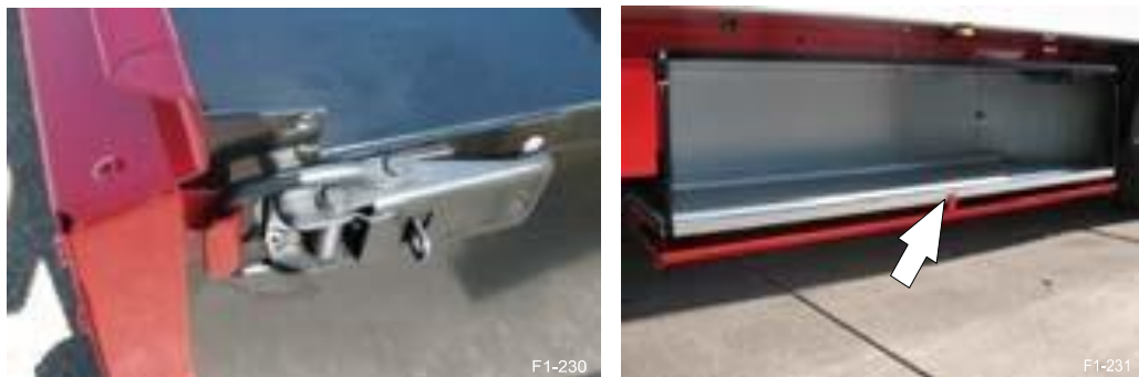
Рисунок 1.14 – Відкидний замок та ящик для зберігання піддонів
