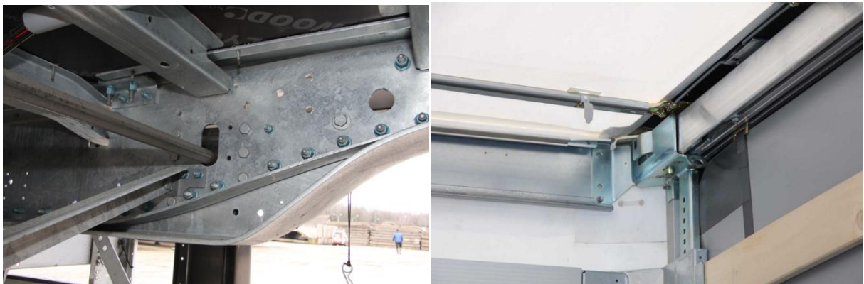
Рисунок 1.3 – Оцинковані конструктивні елементи рами та інших корпусних деталей
