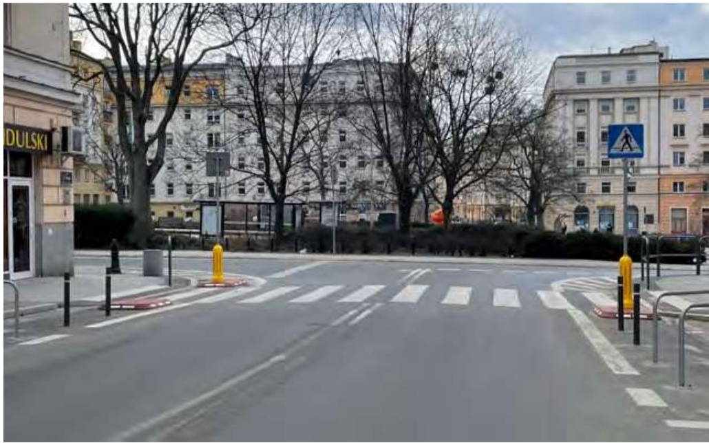
Рисунок 1.7 – Приклад звуженого перерізу дороги за участю розмітки
