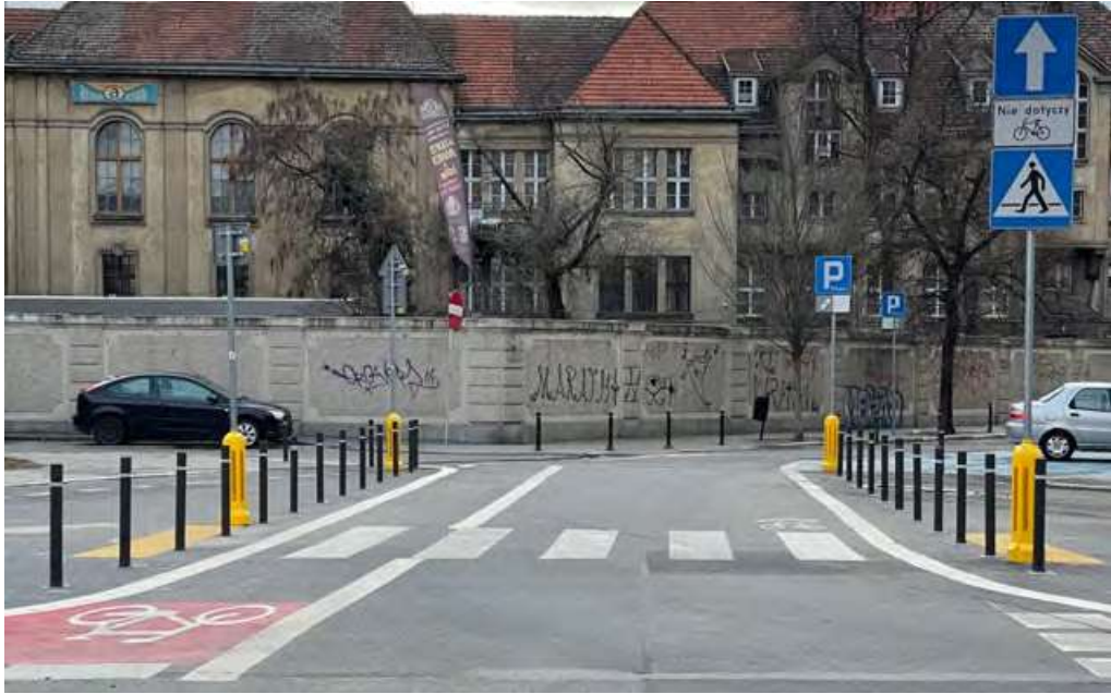
Рисунок 1.10 – Приклад використання велосипедної стільниці на дорозі з одностороннім рухом
